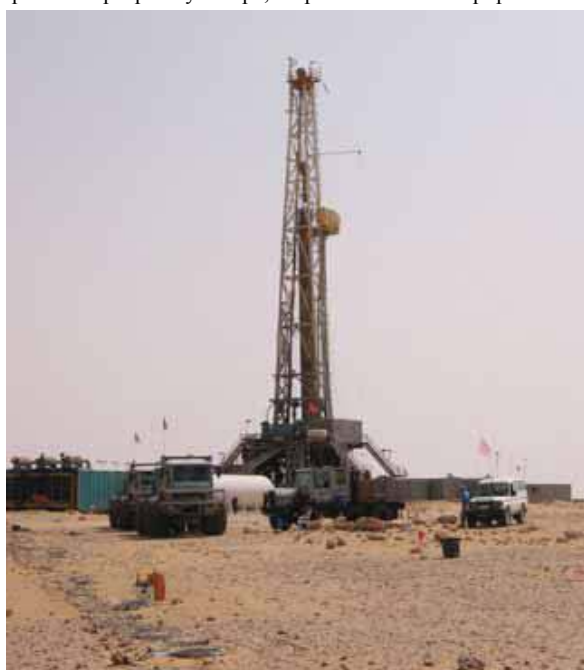
Рис. 1 Фотография, на которой показан вибратор, который служил источником, как для скважинных датчиков, так и для наземных кос геофонов, изображенных на переднем плане.
