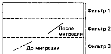
Рис. 4.18. Соотношение между переменной по времени фильтрацией и миграцией. Наклонное вступление до и после миграции попадает в зоны действия разных фильтров.
