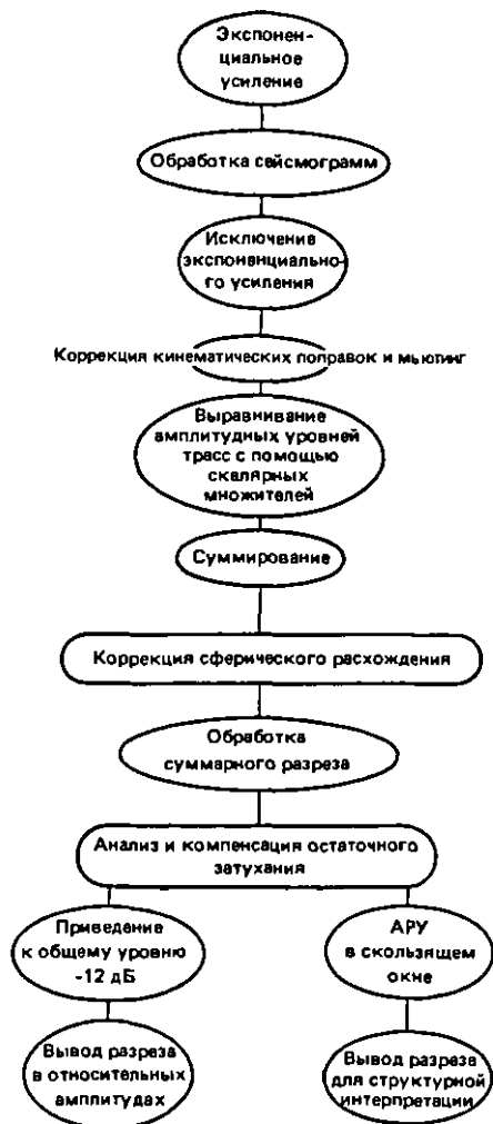
Рис. 3.83. Современная стратегия обработки в плане коррекции усиления.
