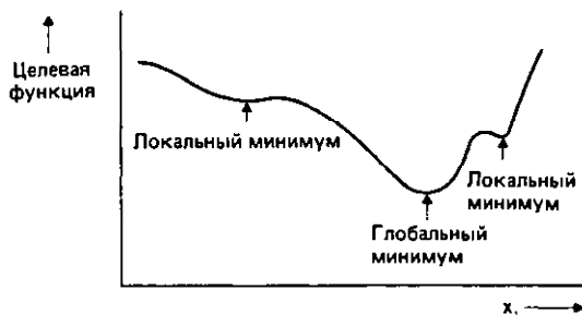
Рис. 5.1. Целевая функция в n -мерном пространстве параметров может иметь любое число локальных минимумов, к которым могут сходиться итерационные алгоритмы, тогда как задача состоит в отыскании глобального минимума.
