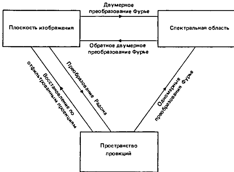
Рис. 5.19. Связи между плоскостью изображения, пространством проекций и двумерной частотной (спектральной) областью.
