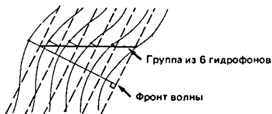
Рис. 3.47. Искажение формы импульса при подходе волны под углом к приемной группе.
