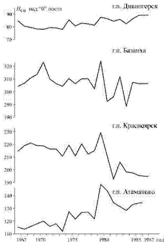
Рис. 3. Изменения уровней воды, соответствующих проектному (меженному) расходу воды по гидрологическим постам в нижнем бьефе Красноярской ГЭС за 1967-1987 гг.
