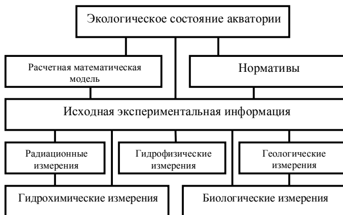
Рисунок 2. Принципиальная схема построения геоэкологического мониторинга морских акваторий.
