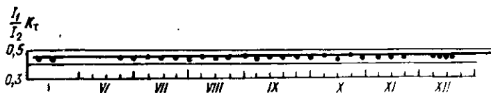
Рис. 2.13. Изменение контрольного отсчета озонметра М-83 со временем. Ашхабад, озонметр № 10.
