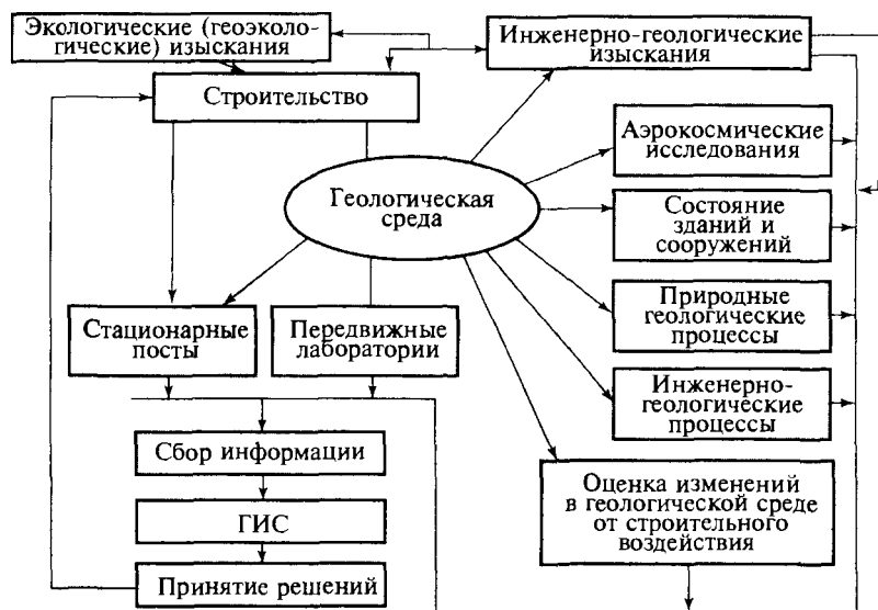
Р и с. 200. Схема геоинформационной системы оценки влияния строительства на геологическую среду
