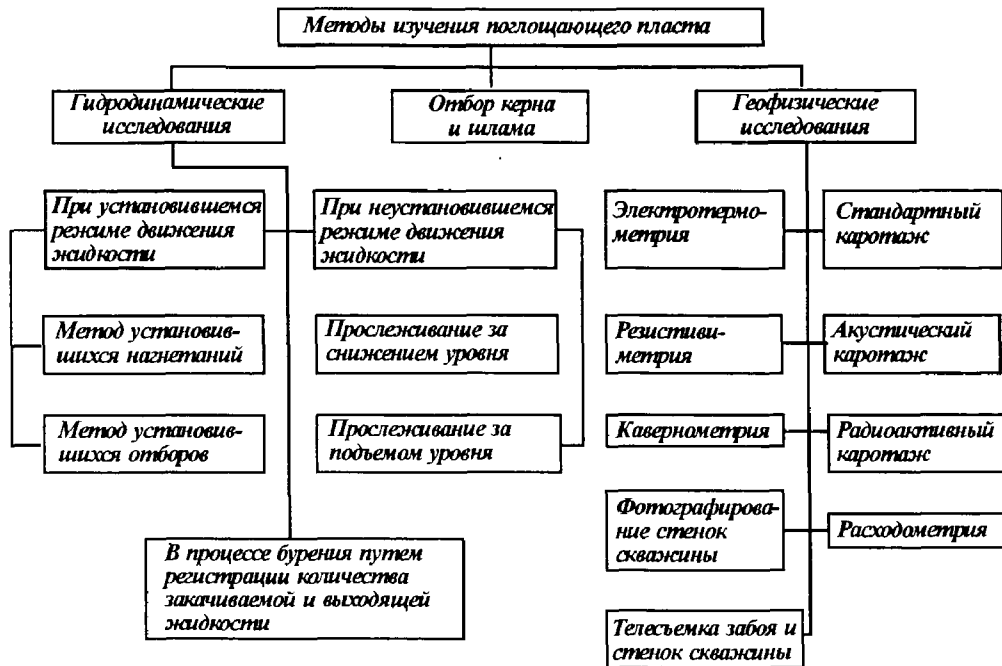
Рис. 2.3. Классификация методов изучения поглощающих пластов (по В.И. Крылову)
