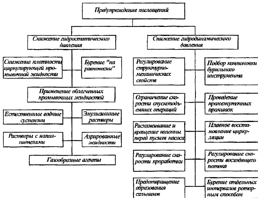
Рис. 2.15. Схема факторов, обуславливающих снижение гидростатического и гидродинамического давлений на стенки скважины
