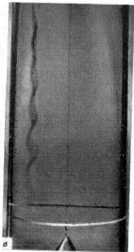
Фото 7.6.5. Волны, порожденные телом, движущимся вдоль оси вращения воды в цилиндре радиуса b , становятся видимыми при падении крупинки марганцевокислого калия непосредственно перед опускающимся телом. Волны стационарны относительно тела. a — видно, что волновое движение происходит ниже по потоку от тела; b — U/b\Omega=0,306 ; возможна только одна форма свободного колебания с длиной волны 1,19b ; в — U/b\Omega=0,163 ; возможны три формы свободных колебаний с длинами волн 0,54b , 0,62b и 0,92b (Тонг (1953)).
