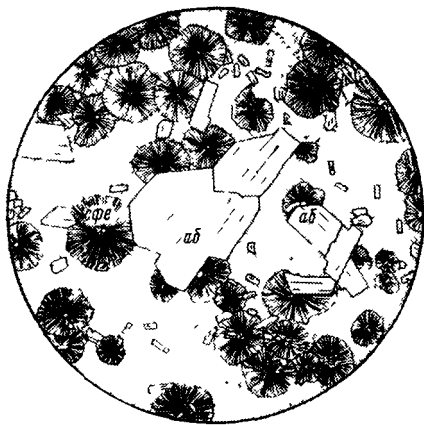
Рис. 64. Фельзитовая структура в сочетании со сферолитовой в альбитофире. Во вкрапленниках альбит (аб); основная масса кварц-полевошпатового состава микрофельзитового строения с включением радиально-волоконистых сферолитов (сфе) (по Ю. Ир. Половинкиной, 1966).
