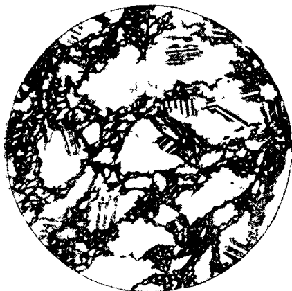
Рис 133 Брекчиевидная структура. Остроугольные обломки гранита погружены в мелкокристаллическую массу той же породы (по Ю Ир Половинкиной, 1966)
