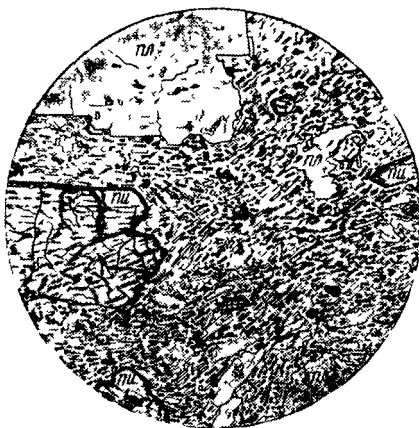
Рис. 65. Пилотакситовая структура основной массы в пироксеновом андезите. Во вкрапленниках плагиоклаз (пл) и моноклинный пироксен (пм); в основной массе субпараллельно ориентированные микролиты плагиоклаза (по Ю. Ир. Половинкиной, 1966).
