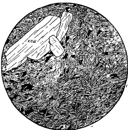
Рис 87 Трахиты с трахитовой структурой (по Ю. Ир. Половинкиной и др., 1948).
