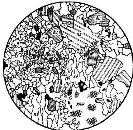
Рис 135 Бластогранитовая структура (пл — плагиоклаз, кпш — калиевый полевой шпат, кв — кварц, би — биотит, м — магнетит) (по Ю Ир. Половинкиной и др, 1948).
