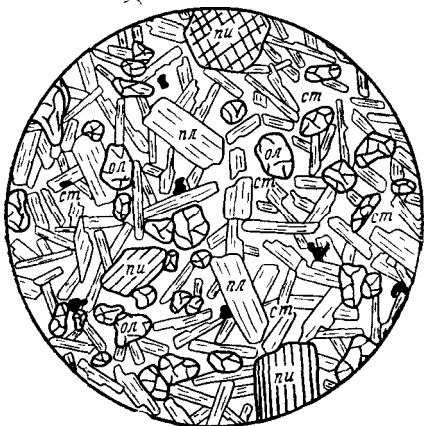
Рис. 63. Интерсертальная (базальтовая) структура основной массы базальта. Общая структура породы микропорфировая. Во вкрапленниках кристаллы оливина (ол), пироксена (пк), плагиоклаза (пл); в основной массе таблички плагиоклаза (пл), промежутки между которыми заполнены стеклом (ст) (по Ю. Ир. Половинкиной и др., 1948).
