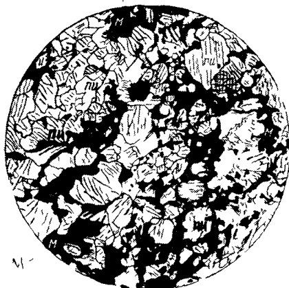
Рис. 59. Сидеронитовая структура в рудном пироксените. Порода состоит из зерен моноклинного пироксена (пи), промежутки между которыми заполнены магнетитом (м) (по Ю. Ир. Половинкиной, 1966)
