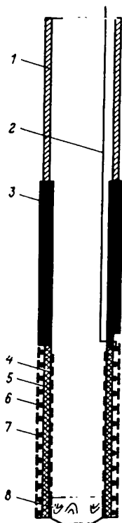
Рис. 55. Схема скважины с защищенным фильтром:
