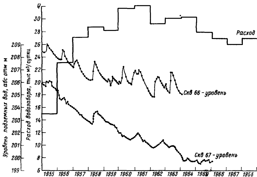
Рис. 9. График изменения уровня подземных вод на участке Б. Слепя и отбора подземных вод на водозаборе «Зеленовка» во времени
