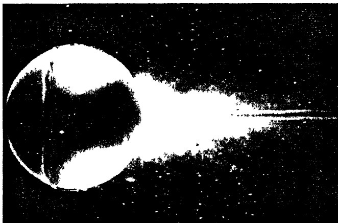
Рис. 16.22. Мгновенная картина обтекания шара с турбулизирующей проволочкой при Re = 30\,000 . Проволочный обруч, надетый на шар перед экватором, возмущает пограничный слой. Слой становится турбулентным и поэтому отрывается ниже по потоку, в отличие от ламинарного (см. рис. 16.21). Сопротивление при этом резко уменьшается до значения, достигаемого на гладком шаре только при числе Рейнольдса, в десять раз превышающем существующее в потоке
