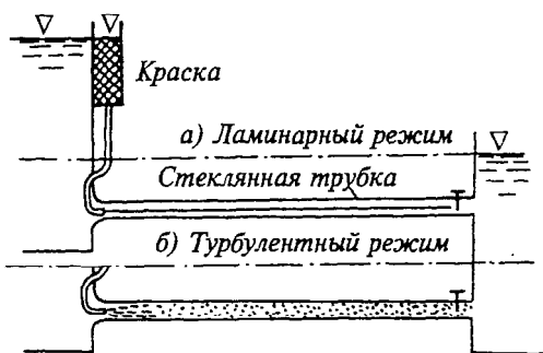
Рис. 5.12. Прибор Рейнольдса для изучения режимов движения жидкости
