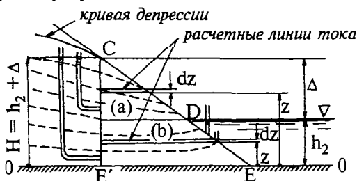
Рис. 13.19. Расчетная схема резкоизменяющегося фильтрационного потока в грунтовой плотине
