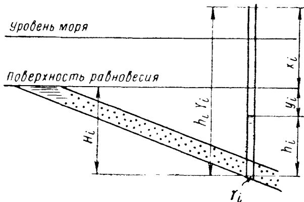
Рис. II.6. Соотношение «поверхности равновесия» и уровней подземных вод (по В. В. Ягодину).
