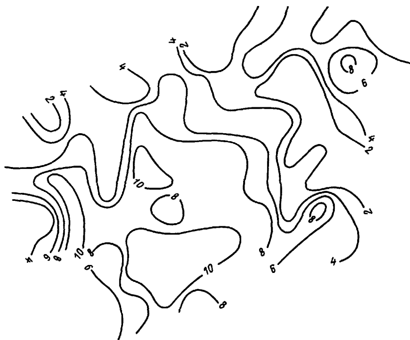
Рис 63. Мощность зоны охристых руд (в м) на месторождении никеля. По данным У. Лаваут
