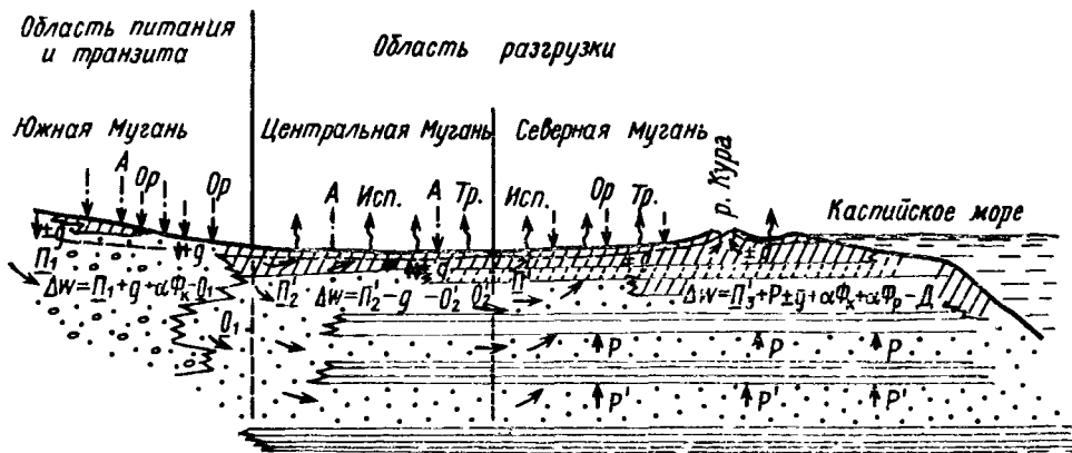
Рис. 21. Схема структуры водного баланса Муганской равнины: \Delta W — изменения запасов грунтовых вод; A — атмосферные осадки; Op — оросительные воды; Исп — испарение; Тр — транспирация; O — подземный отток; \underline{П} — подземный приток; +g — инфильтрационное питание грунтовых вод за счет атмосферных осадков (Южная, Центральная Мугань), инфильтрации на орошаемых полях (Южная, Северная Мугань); \alpha\Phi_k — питание грунтовых вод за счет фильтрации из каналов и \alpha\Phi_r — р. Куры; D — дренажный сток; P — напорное питание грунтовых вод
