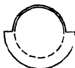
Рис. 26. Цилиндр для отбора образцов пород с ненарушенной структурой
