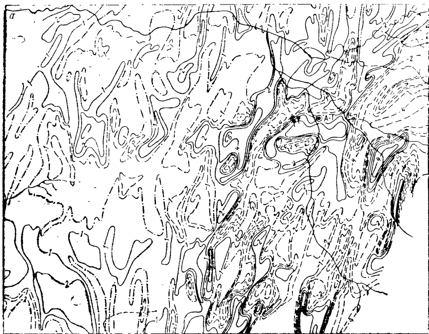
Рис. 18. Результаты магнито- и электроразведочных работ на участке «Горячий пляж»: а — карта изодинам \Delta Z ; б — карта изоом \rho_k по данным электропрофиллирования с раз \rho_k , Ом·м
