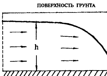
Рис. 3.1. Постоянство напора в поперечном сечении потока (гидравлическое приближение)
