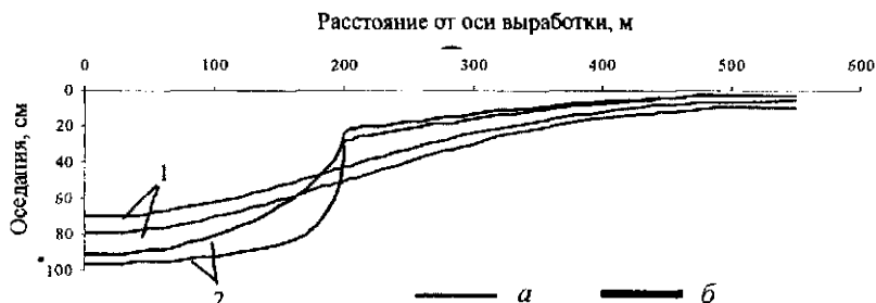
Рис.1.6. Графики расчетных оседаний пород подработанной толщи на земной поверхности (1) и на уровне кровли пласта (2) в сплошном массиве пород (а) и в массиве с хаотической трещиноватостью (б)
