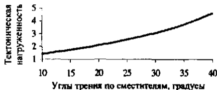
Рис.7.3. Зависимость тектонической нагруженности T_H в тектонически напряженных зонах от угла трения на контактах разломов
