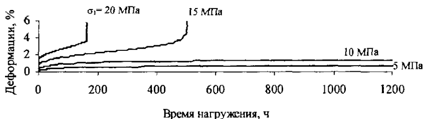
Рис.4.8. Деформации ползучести цилиндрических образцов при различных осевых нагрузках
