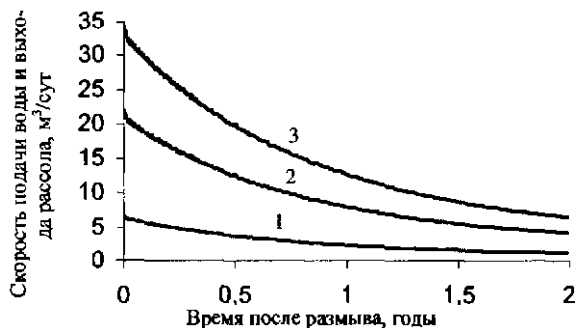
Рис 9.8. Графики скорости подачи воды и выдачи рассолов при размыве без изменения радиуса камеры
