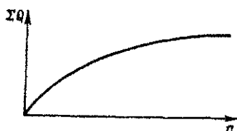
Рис. 4.22. Зависимость суммарного дебита нефтяного месторождения от числа скважин
