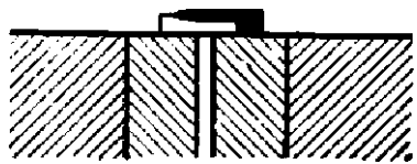
Рис. 208. Приспособление для измерения сопротивления трения
