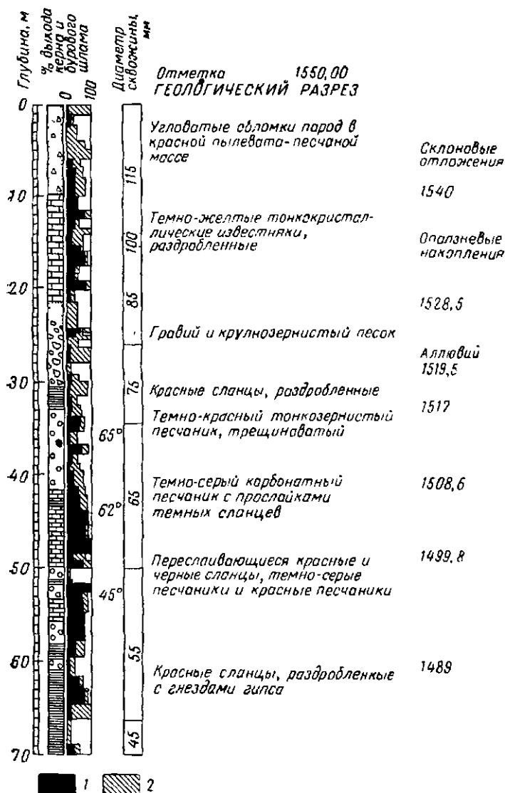
Фиг. 5. Типичный геологический разрез скважины № 24 на участке плотины Лятнан.
