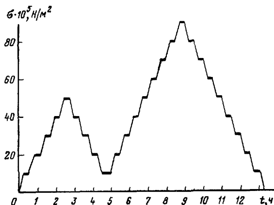
Рис. 3. Схема приложения нагрузок на штампы
