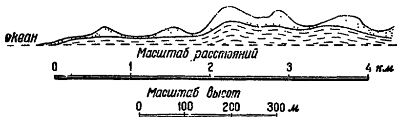
Рис. 83. Поверхность уровня грунтовых вод в дюнах Гаскови (по Daubrée).
