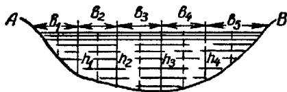
Рис. 37. Схема створа для определения расхода воды
