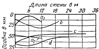
Рис. 175. Кривые осадок длинных узких ленточных фундаментов, несущих кирпичные стены
