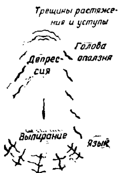
Рис. 151. План типичного оползня в связном грунте
