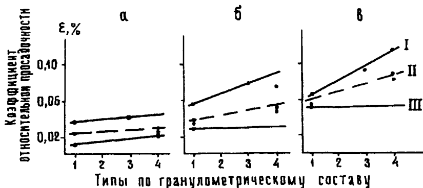
Рис. 21. Зависимость величины относительной просадочности искусственно сформированных образцов в воздушно-сухом состоянии от их гранулометрического состава. Условные обозначения те же, что и для рис. 20, исключение — мощность слоя осадка, формируемого за один этап, 1 см (по В.Т. Трофимову и Е.Ю. Куликовой, 1995)
