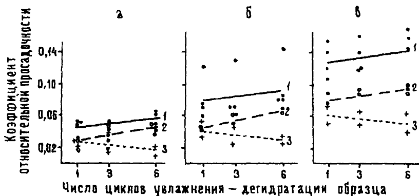
Рис. 23. Зависимость величины относительной просадочности воздушно-сухих искусственно сформированных образцов—аналогов золовых лёссовых отложений от количества циклов увлажнения-дегидратации при давлениях 0,05 (а), 0,1 (б) и 0,3 МПа (в). Мощность слоя осадка, формируемого за один этап, 3 см; температура на его поверхности 20°; дополнительной нагрузки нет; 1 — суглинок тяжелый; 2 — суглинок средний; 3 — супесь (по В.Т. Трофимову и Е.Ю. Куликовой, 1995)
