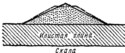
Рис. 1.11. Длительная осадка насыпи за счет выдавливания слоя глинистого грунта
