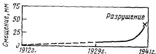
Рис. 5.17. Данные наблюдений за смещением подпорной стенки в Кензал Грин (Англия) в результате длительного прогрессирующего течения грунта
