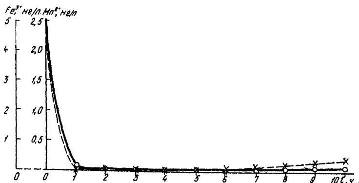
Рис. 11.2. Удаление марганца и железа \text{Fe}^{2+} перманганатом калия — остаточное содержание марганца; — — — остаточное содержание железа
