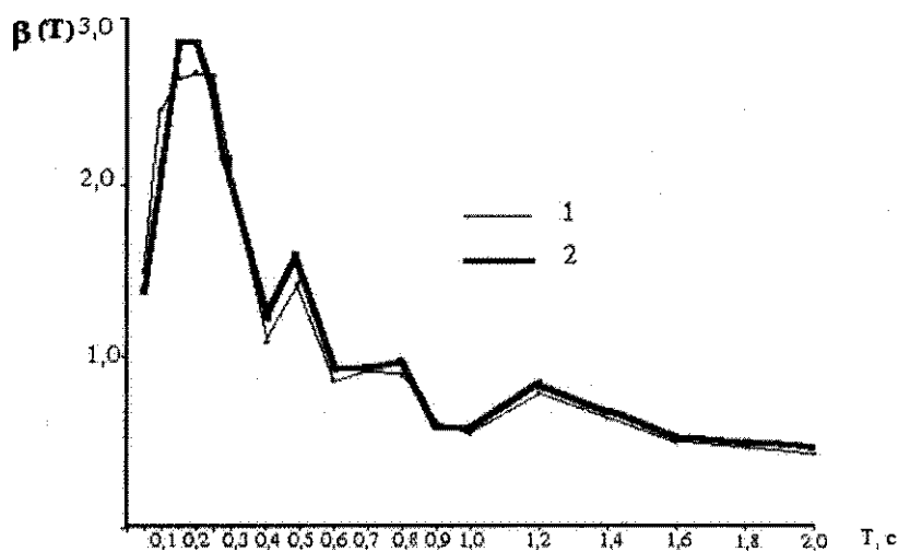
Рис. 3.4. Графики коэффициента динамичности \beta(T) для: 1- участок распространения гравийно-галечниковой гонимы (разрез типа 1), T_{\text{max}}=145 \text{ м/с}^2 , T_{\text{max}}=0,15 \text{ с} ; 2- участок с мощностью суглинков до 2-5 м, залегающих на гравийно-галечниковых отложениях (разрез типа 2), a_{\text{max}}=212 \text{ см/с}^2 , T_{\text{max}}=0,16 \text{ с} . Зона 7 баллов на рис. 3.3
