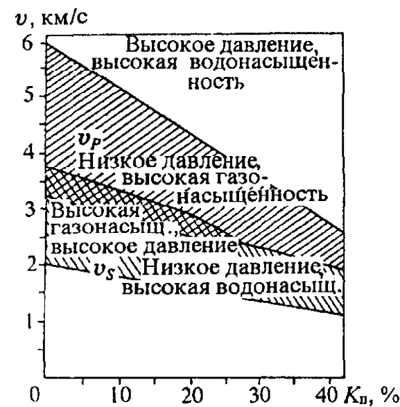
Рис. 2.10. Влияние насыщенности флюидами и всестороннего давления на скорости продольных и поперечных волн в различных сцементированных осадочных породах. Давление изменяется в пределах 0—70 МПа.
