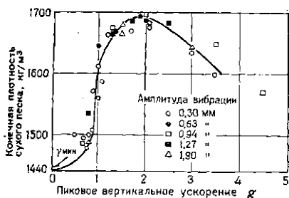
Рис. 4.27. Влияние интенсивности ускорения на уплотнение песков при испытаниях на вибростоле с вертикальными колебаниями [D'Appolonia and D'Appolonia, 1967]
