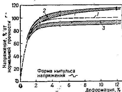
Рис. 4.11. Сравнение прочности при нормальной и пульсирующей нагрузках для ненарушенных образцов пылеватых глин [Seed and Chan, 1966].
