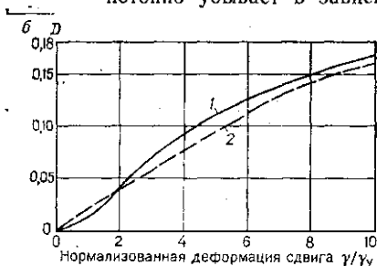
Рис. 4.7. Сравнение экспериментальных значений нормализованного модуля сдвига G/G_{\max} (а) и коэффициента затухания D (б) с моделью Рамберга — Осгуда для сухих песков [Dobry, 1970].
