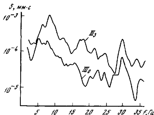
Р и с. 5.12. Амплитудные спектры колебаний в точке III III 0 — фон; III 3 — проходят три автомашины
