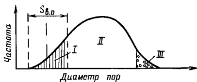
Рис. 4.37. Распределение насыщенности при наличии трех фаз.
