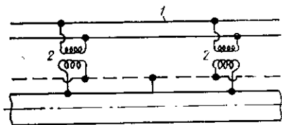
Рис. 7.2-17. Электроподогрев трубопровода (Паскуалини, 1950)
