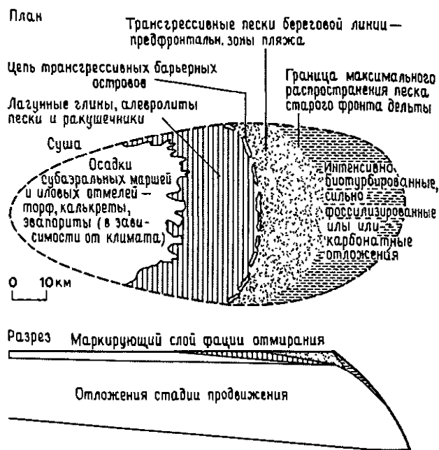
Рис. 6.33. Обобщенный разрез маркирующих слоев фаций отмирания (799, 711, 1174, с изменениями).
