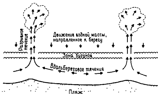
Рис. 7.5. Прибрежная система циркуляции, образуемая волнами и состоящая из вдольбереговых течений и направленных от берега разрывных течений [2233].
