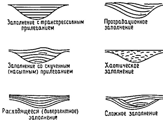
Рис. 2.8. Примеры конфигурации сейсмических отражений от заполнений отрицательных форм рельефа в подстилающих слоях. Нижележащие отражающие горизонты могут быть либо срезаны, либо залегать согласно с отражателями заполнения [1685].
