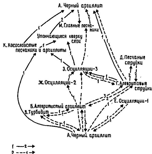
Рис. 2.1. Диаграмма взаимоотношений фаций для дельтовой формации Абботсхэм, показывающая, сколько раз фации находятся в вертикальном контакте друг с другом, и типы границ между ними (по [1959]). 1 — резкий контакт между фациями, встречен дважды; 2 — постепенный переход между фациями, встречен один раз.
