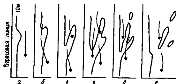
Рис. 9.18. Модель прогрессивного отделения и изоляции прибрежных отмелей и их превращения в прибрежные линейные гребни [782]. а, б — начальная стадия; в, г — рост путем аккреции отмели и размыва впадины; д, е — отделение и начало образования новой отмели.
