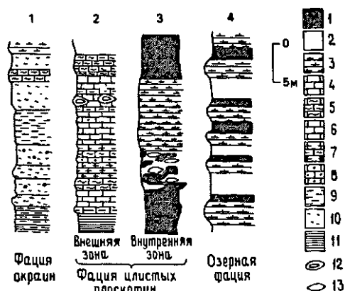
Рис. 4.25. Литологические колонки фации окраин, фации илистых отложений и озерной фации формации Грин-Ривер [2382]. 1 — битуминозные сланцы; 2 — трона; 3 — доломиты; 4 — известняки; 5 — строматолитовые известняки; 6 — кластогенные карбонатные пески; 7 — кластогенные карбонатные алевроиты; 8 — оолитовые известняки; 9 — алевролиты; 10 — песчаники; 11 — аргиллиты; 12 — инкрустированные стебли и корни водорослей; 13 — линзы доломита.
