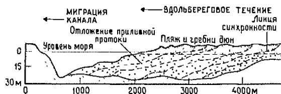
Рис. 7.29. Песчаное тело с эрозионным основанием, образованное латеральной миграцией приливной протоки в барьерном острове в условиях смешанного волнового приливно-отливного режима.
