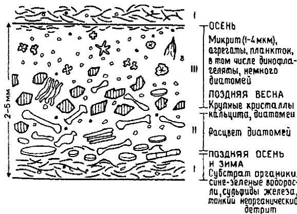
Рис. 4.8. Схематический вид типичной неледниковой варвы из Цюрихского озера, Швейцария. Элементы I и II образуют позднеосеннюю — зимнюю (темную) ламину, элемент III — поздневесеннюю — летнюю (светлую) ламину [1328].
