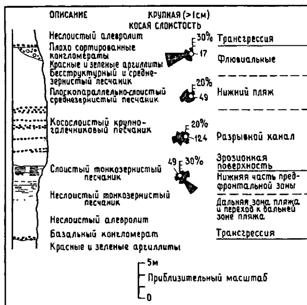
Рис. 7.22. Разрез с укрупнением зернистости пород вверх сформирован в миоцене наступанием пляжа с системой барьеров, Калифорния. Поверхность размыва в середине разреза является основанием отложений канала разрывного течения. Происходит смена направления движения волн от косого юго-восточного в сторону суши над береговым склоном к направлению течения в разрывном канале в сторону моря на восток.
