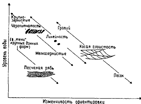
Рис. 3.6. Вероятные соотношения между отметкой воды в реке и типом и изменчивостью ориентировки активных структур на дне смешанного песчано-гравийного русла. Следует обратить внимание на то, что песчаная рябь расположена на графике в стороне от главного тренда. Она, как правило, попадает в тропы крупных русел, и ее ориентировка определяется ими [255].
