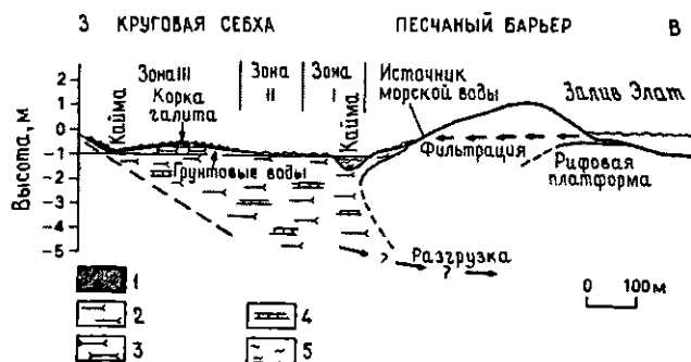
Рис.8.18. Обобщенный разрез через себху Раунд в Набхе (залив Эйлат), показывающий соленость воды, основной состав осадков в каждой топографической зоне и предполагаемую гидродинамическую систему [913]. 1 — галит; 2 — гипс; 3 — ангидрит; 4 — карбонатный ил; 5 — водоросли.
