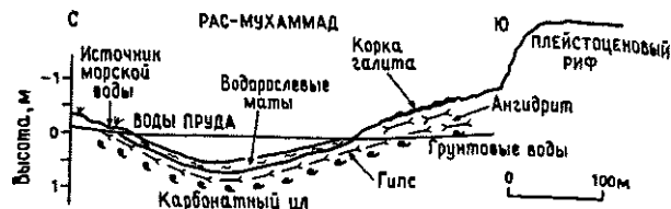
Рис.8.19. Общий разрез через пруд Рас-Мухаммад, показывающий основные компоненты осадка [913].
