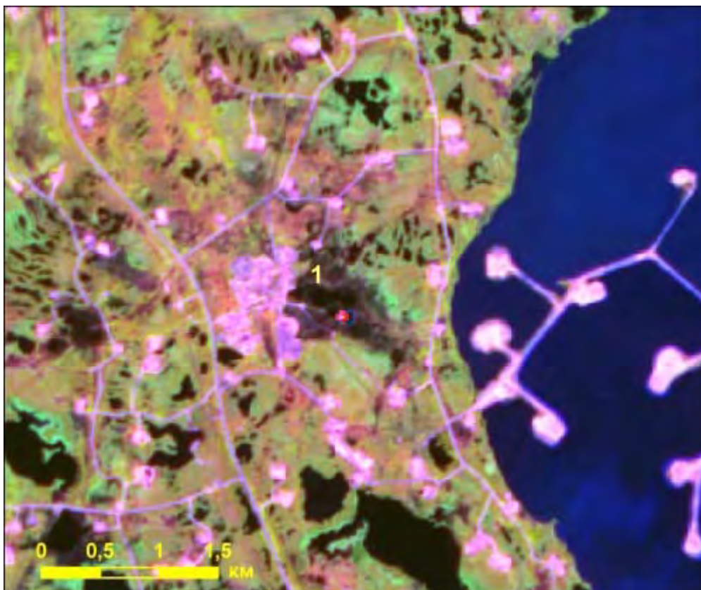
Рис. 5-А. Самотлорское месторождение. Снимок Terra/Aster. Пространственное разрешение 15 м. Дата съемки 2 июля 2002 г. Масштаб 1:50000. Участок, загрязнённый нефтепродуктами. Цифрой 1 обозначено загрязнение, скрытое вторичной растительностью
