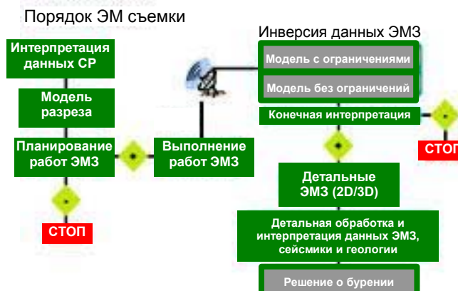
Рис. 2. Пример процесса проведения морских ЭМЗ. В основе лежит идея того, что в данных по УЭС прямо выражается наличие углеводородов. В таком случае первый проход позволяет выделить непроводящие зоны. Если такие зоны выделены, проводится вторая, более детальная съемка, которая даст больше информации о непроводящих объектах, которую можно эффективно использовать при комплексной интерпретации.
