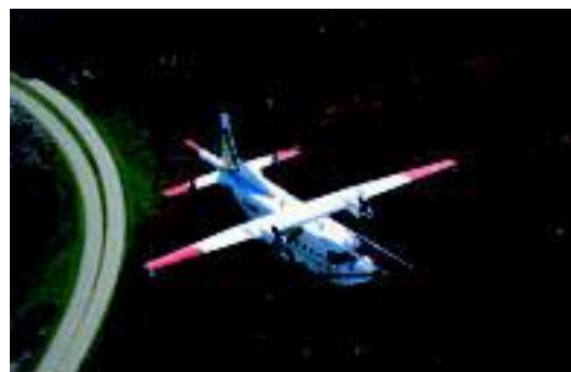
Рисунок 1 Самолет CASA 212, оснащенный шестью многожильными проводами системы GEOTEM, размещенными в носовой и хвостовой части самолета, а также на концах крыльев.
