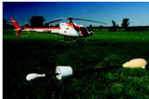
Рисунок 6 Сенсорный зонд. ЭМ датчики находятся в больших желтых гнездах, а магнитометры в маленьких белых гнездах.
