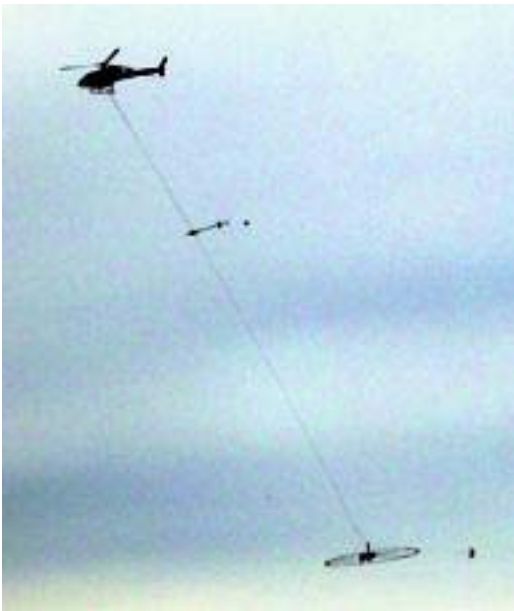
Рисунок 3 Система HeliGEOTEM, включающая в себя вертолет (сверху), приемники и магнитометр (в середине) и источник (в самом низу).
