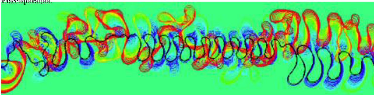
Рисунок 1 Меандрирующей центральной линии канала, используемая для 3D моделирования коллектора из фации канала.
