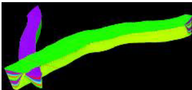
Рисунок 6 Пример моделирования русловых резервуаров при отсутствии пойменных отложений (Изображение создано SBED).
