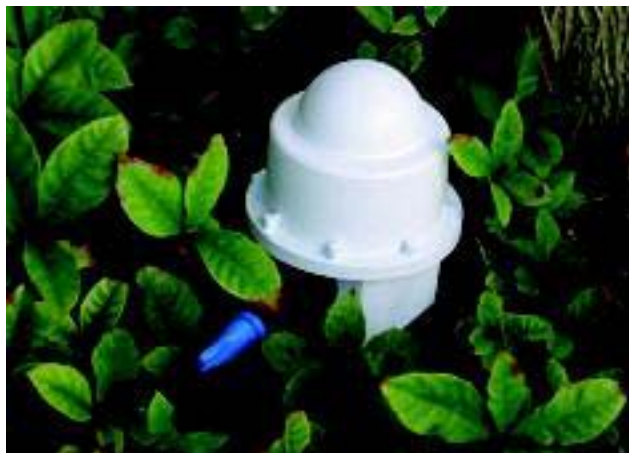
УЧС Unit со встроенными антенной и батареей.
