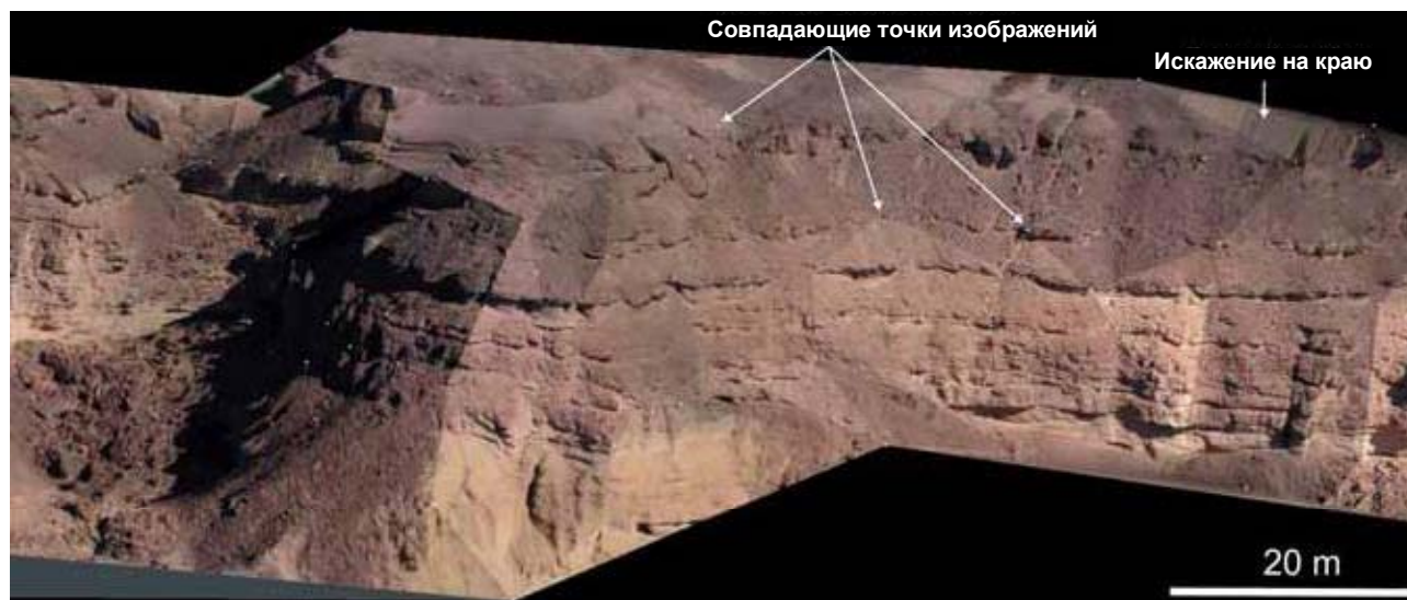
Рис. 3. Цифровая модель поверхности третичных отложений приливных равнин и русловых отложений формации Нухул, Суэцкий залив, Египет. При построении ЦММ и текстурной заливки с помощью соответствующих программ объединено по контрольным точкам (см. рис.) и исправлено за краевые эффекты 20 фотоснимков с расстояния 10–50 м. Полученная модель стала основой, на которую выносились данные других методов.
