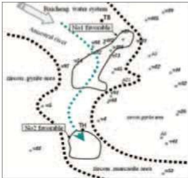
Рис. 6. Положение погребенного русла реки по результатам проб тяжелых минералов
