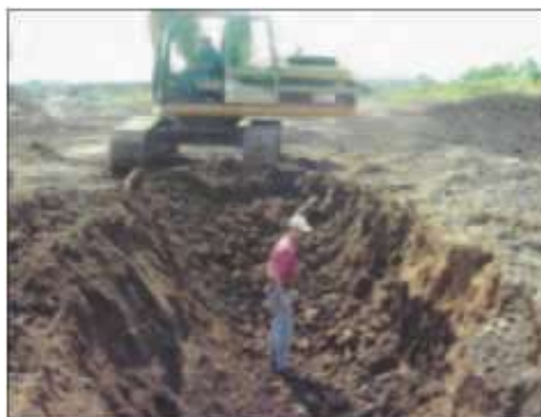
Рис. 7. Фотография синего участка с рис. 6 после проверки результатов. Можно заметить, что эта область использовалась для свалки не шлака, а строительного щебня.
