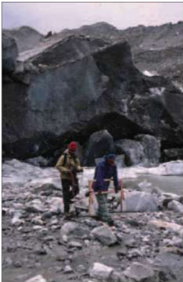
Рис 5 Фотография работы с георадаром, полученная по ледяному шлейфу перед активным айсбергообразующим ледником Trakarding. Озеро Tsho Rolpa справа от этой картины.
