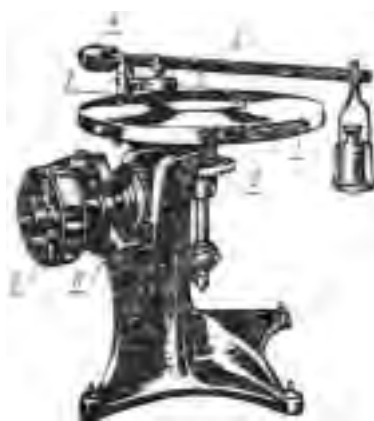
1 - истирающий диск; 2 - двуплечий рычаг; 3 - образец; 4 - противовес; 5 - зубчатая передача; 6 - шкив; 7 - держатель; 8 - счетчик оборотов Черт. 2
