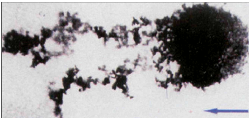
Рис. 6. Нарушение фильтрации в колонне с забитыми капиллярами (физическое моделирование и математические вычисления, проведены в Институте гидродинамики, Новосибирск, Россия).
