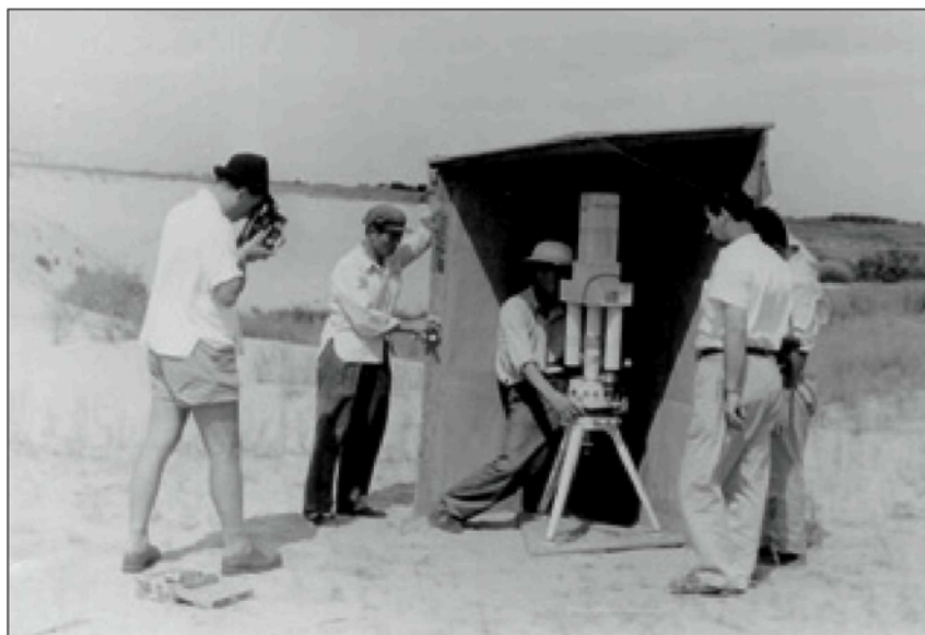
Крутильный маятник Этвеша при работе в Китае.
