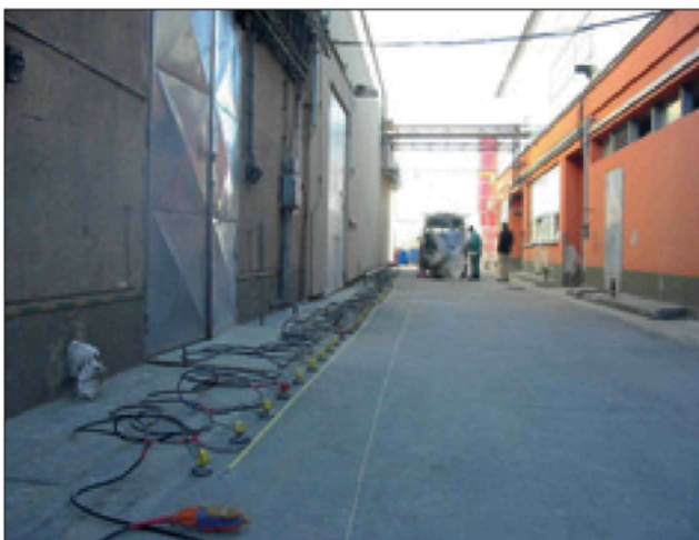
Малоглубинные сейсмические измерения на промышленном объекте для обнаружения полостей.
