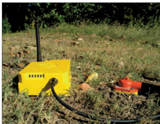
Рисунок 4 FSU (полевой блок станции) - сердце беспроводной системы FireFly компании I/O. FSU, разработанная как полностью автономный блок станции, она уменьшает вес системы FireFly и упрощает ее развертывание. Когда сейсморазведка не ограничивается косами, геофизики свободны в разработке схемы съемки 3D и используют шаг дискретизации, который гармонирует с картируемыми объектами разреза.
